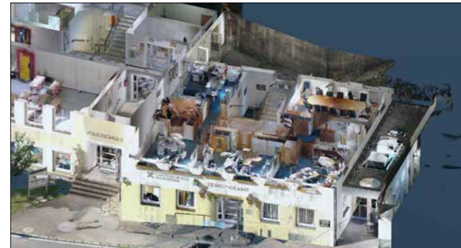
Laserscan-Bestandsaufnahme Gemeindeamt/Volksschule durch die Fa. Planimio. Der Gebäudebestand wird in 3D und millimetergenau dargestellt.
