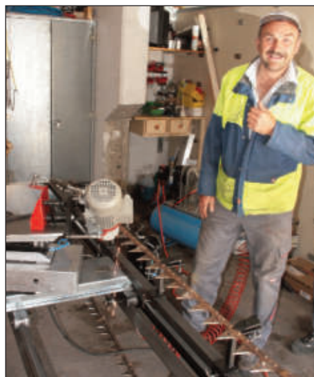
Hubert Bergmann, ein Enkel des Erfinders der ersten Güterseilbahn, ging selbst unter die Erfinder. So baute er eine halbautomatische Maschine zum Schleifen von Mähmaschinenmessern für unterschiedliche Längen. Bravo Hubert!
