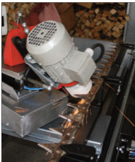
Hubert Bergmann, ein Enkel des Erfinders der ersten Güterseilbahn, ging selbst unter die Erfinder. So baute er eine halbautomatische Maschine zum Schleifen von Mähmaschinenmessern für unterschiedliche Längen. Bravo Hubert!
